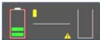
2. Alarm, dass die Batterie tiefentladen ist - wenn dieser Zustand erkannt wird, blinkt das untenstehende Muster im Display und ein hörbarer Alarm fordert dazu auf, das Gerät von der Netzspannung zu trennen. Bitte kontaktieren Sie in diesem Fall den Kundendienst von AMETEK Powervar unter 1-800-369-7179, um die Batterie zu ersetzen.
