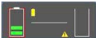
2. Alerte de batterie profondément déchargée : lorsque cette condition est détectée, le symbole ci-dessous clignote et l'alarme sonore se déclenche, indiquant de couper l'alimentation CA et de contacter le service AMETEK Powervar au 1-800-369-7179 pour procéder au remplacement de la batterie.
